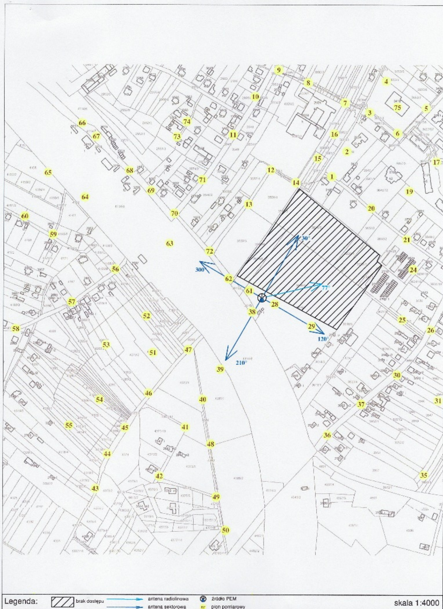
Rys. 2 Lokalizacja pionów pomiarowych
