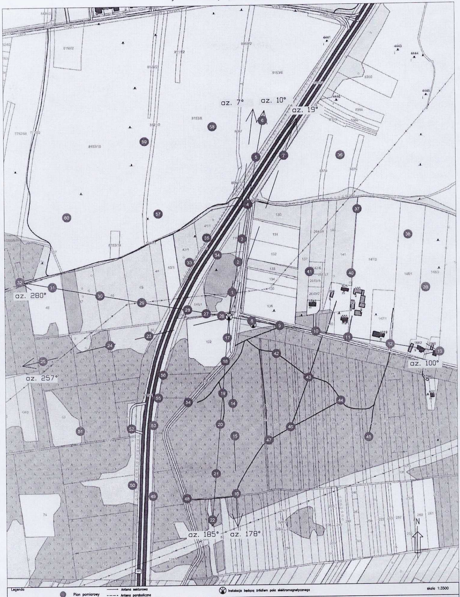
Rys.1 Lokalizacja pionów pomiarowych
